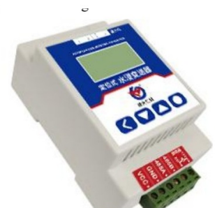
ตัวเครื่องพลาสติกติดตั้งบนราง DIN
